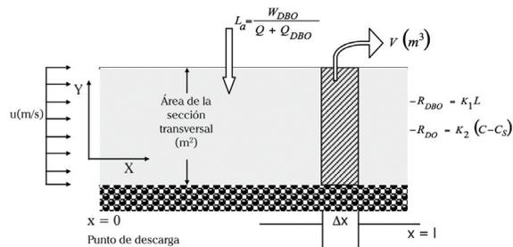
FIGURA 4. MODELO COMPLETO DE DESCARGA DE UN MATERIAL CONTAMINANTE EN UN RÍO.
