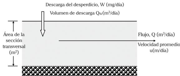
FIGURA 3. MODELO DE DESCARGA DE UN MATERIAL CONTAMINANTE EN UN RÍO.
